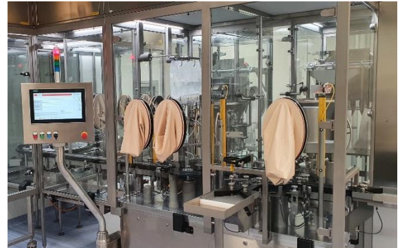
Figura 14 - Macchina di riempimento FM-001
